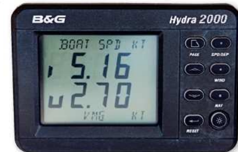
Zusatzinformation: Schon allein aus der Vernetzung von Logge und Windinstrument lässt sich die „Velocity Made Good“ errechnen, die hilft, einen Kreuzkurs zu optimieren
