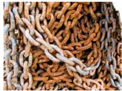
Eine galvanisierte Ankerkette nach nur drei Jahren Ankern in Atollen.
