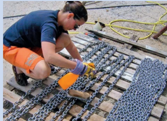
Eine Edelstahlkette sollte mindestens einmal jährlich von Oberflächenrost befreit und genau auf Lochfraß untersucht werden
