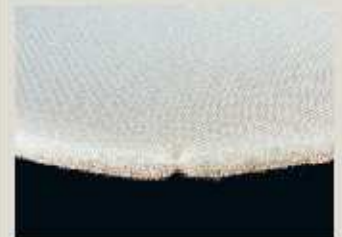
▲ Charmeuse: Die feine Stofflage verhindert das schädliche Eindringen von Klebstoff in die Schaumkaschierung
