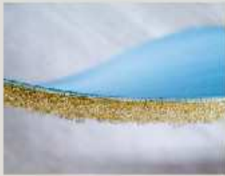
▲ Dreischichtiger Aufbau einer hochwertigen Wandverkleidung für Yachten
