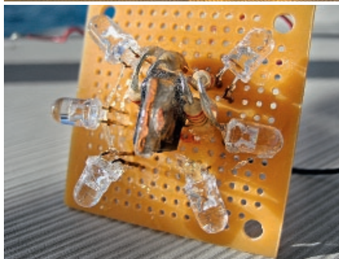
Lange Lebensdauer: Die erste LED-Ankerlaterne im Eigenbau ist auch nach vier Jahren immer noch im Einsatz
