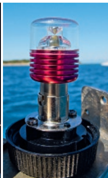
Nicht zugelassene Nachrüst-LED in Positionslaterne: Im Schadensfall ist der Ärger mit der Versicherung vorprogrammiert
